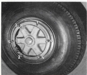
Ordre de serrage des roues avant
