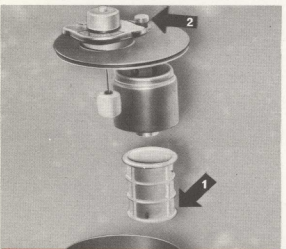
Élément filtrant avec pions magnétiques (1). Soupape de dégazage (2) 23
