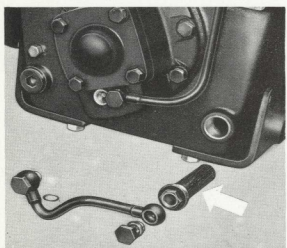
Nettoyage du filtre sur boîte relais
