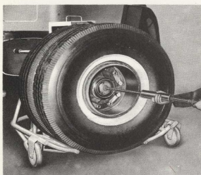
Extraction du joint d'étanchéité du moyeu arrière 29
