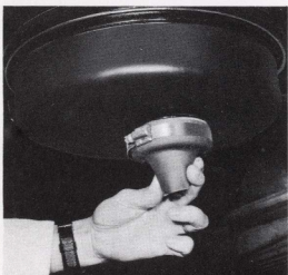
Vidange de la valve évacuatrice
